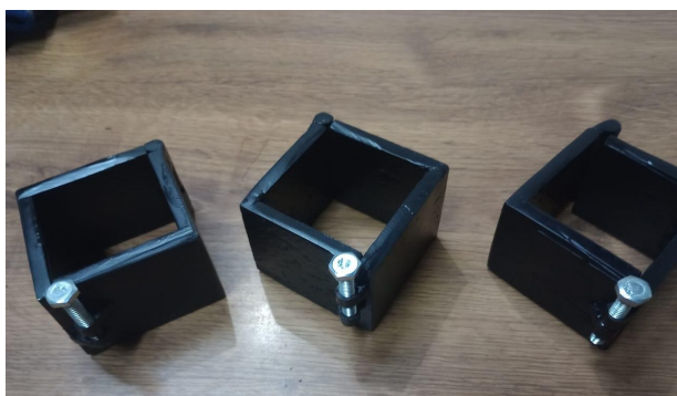
Fig. 5. Unión de las Placas rectificadas con dimensione de 5 cm x 5 cm x 0.7 cm.
