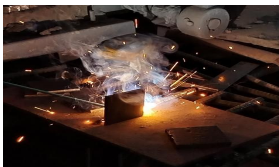
Fig. 4. Unión de las Placas rectificadas con dimensione de 5 cm x 5 cm x 0.7 cm.
