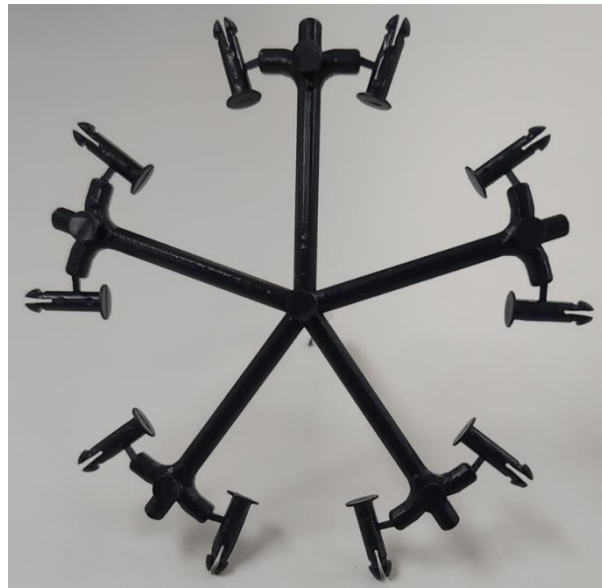
Fig. 6. Piezas inyectadas más la colada que sale del molde.
