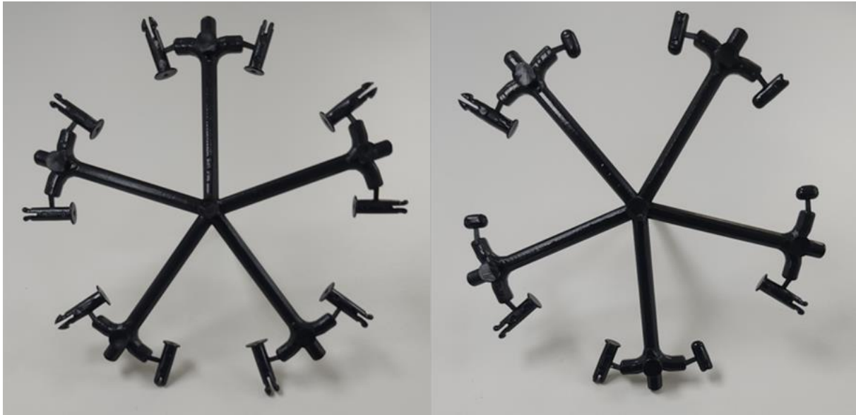
Fig. 23. Piezas con tiro corto. a) modificación en tiempo de inyección y sostenimiento. b) modificación en velocidad y presión de inyección.
