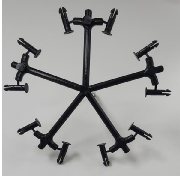
Fig. 25. Piezas con sobre compactación.
