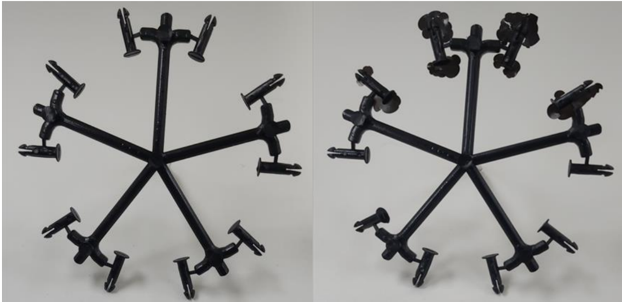
Fig. 27. Piezas con rebaba. a) modificación de temperaturas. b) modificación de velocidad y presión de inyección.
