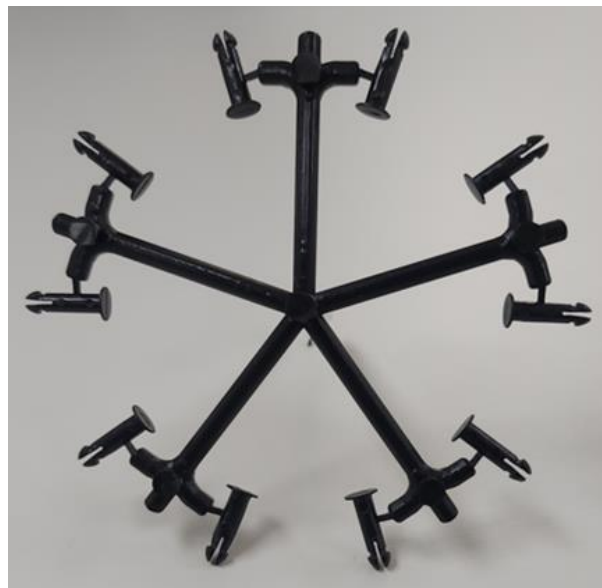
Fig. 19. Piezas en condiciones normales, sin problemas estéticos evidentes.
