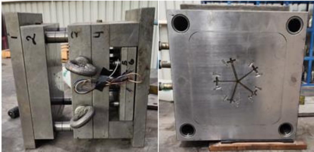
Fig. 9. a) Molde de inyección instrumentado. b) Cavity con la geometría de la pieza y la colada fría.
