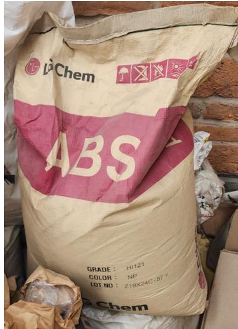
Fig. 7. Material ABS grado HI121 de la marca LG Chem utilizado en la investigación.
