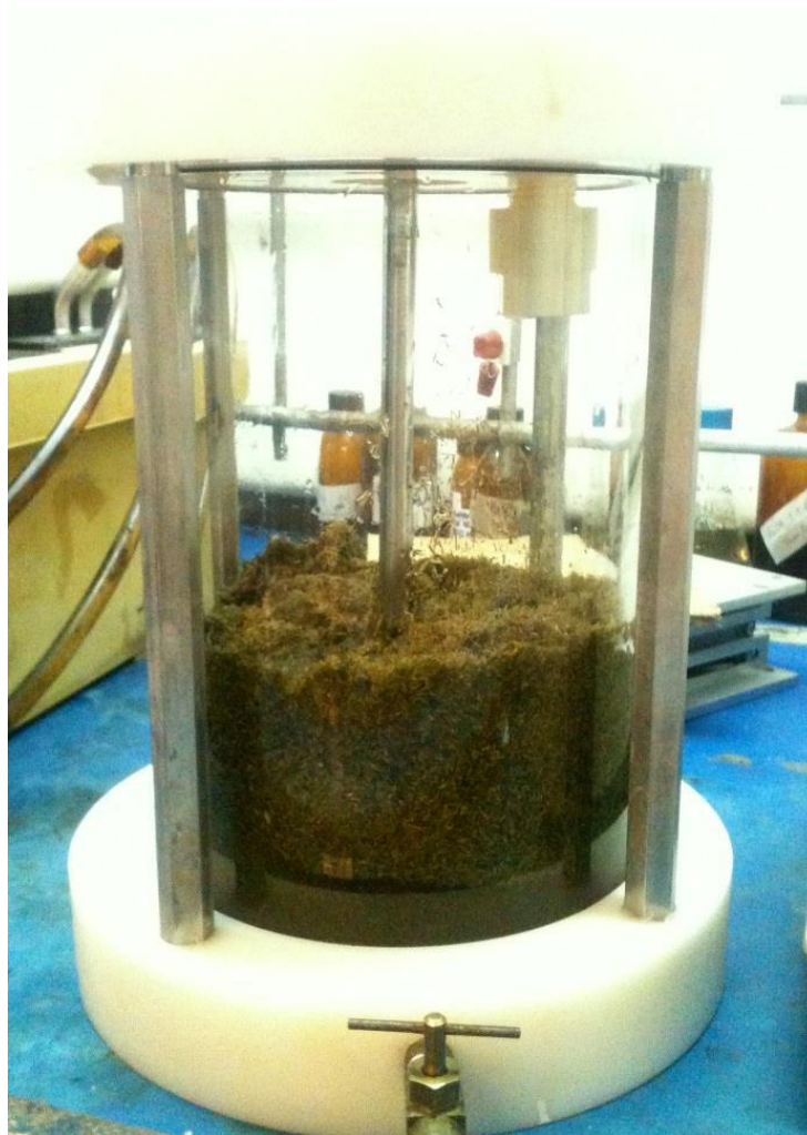
Fig. 13. Celda de ultrafiltración.
