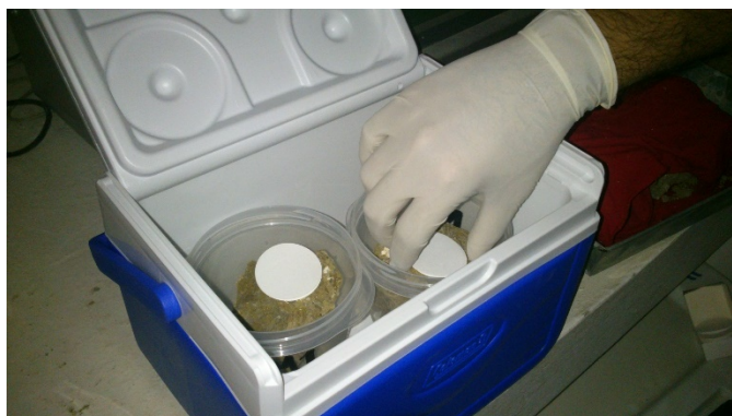
Figura 8. Posicionamiento del papel filtro sobre la muestra.
