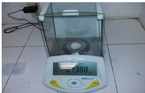
Figura 10. Obtención de la masa del papel de filtro.
