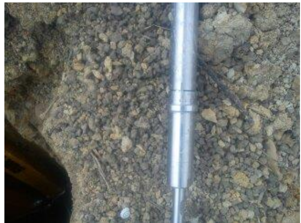
Fig. 6 Ajuste de la veleta y accesorios
