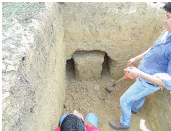
Fig. 5. Preparación de la muestra no. 2 para la extracción.
