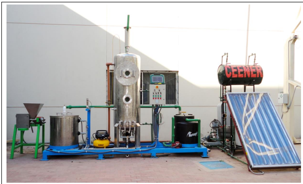
Fig. 6. Digestor anaeróbico UASB a escala piloto acoplado a un subsistema de calentamiento solar y a una torre de enfriamiento.
