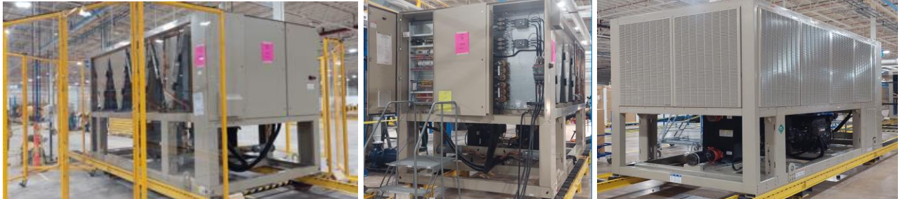
Figura 6.- A la izquierda unidad en prueba de fuga, unidad en prueba eléctrica y unidad lista para ser empacada.
