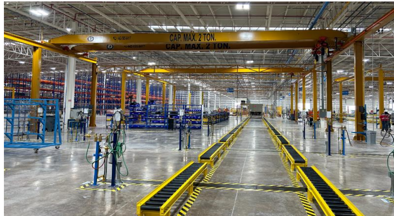
Figura 9.- Línea de ensamble donde se muestran estaciones delimitadas
