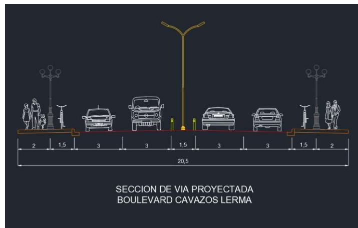
Ilustración VII. Sección transversal del Boulevard
